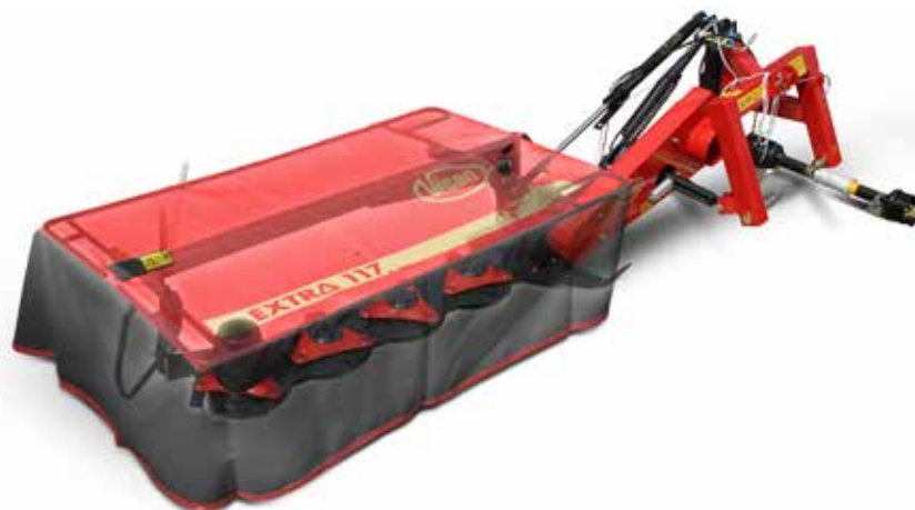
EXTRA 117: Cuatro discos y 1,65 m de ancho de trabajo.
