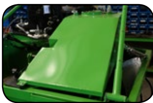
18 DEPÓSITO DE ACEITE HIDRÁULICO
