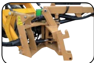
Movimiento lateral paraguas + pinza (instalado en SOLANO HORIZONTE)
