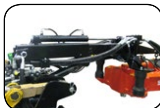
Extensible vibrador de 400 mm (instalado en Solano Horizonte)
