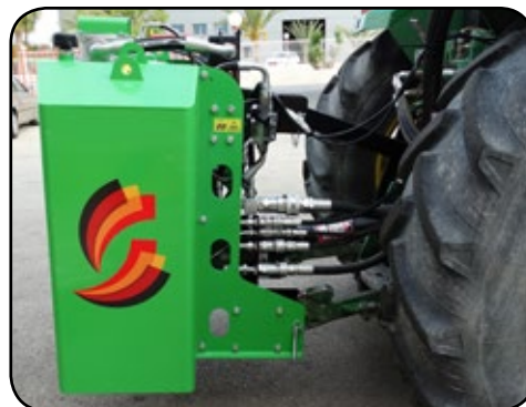
Central hidráulica trasera para recolectores delanteros.
