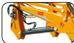
Bombines de elevación reforzados en pala nueva (instalada en Solano Hor.)
