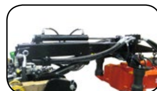
Extensible vibrador de 400 mm (instalado en Solano Horizonte)
